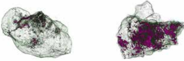
Şekil 4 – Çatlak Hacmi ve Yayılma, Çeneli Kırıcı (Sol), HPGR (Sağ) (Lin ve Miller, 2010)
